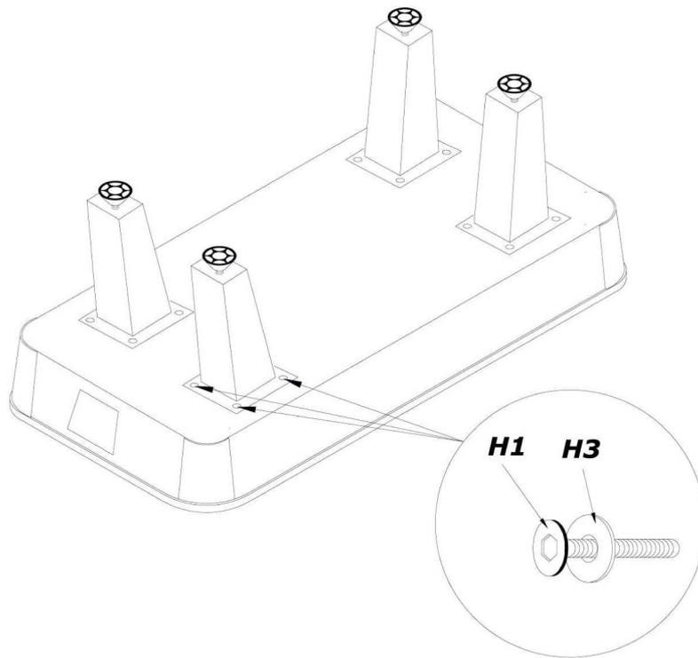
**Étape 2 / Step 2 :** Fixez la partie supérieure à l'aide des 8 boulons 5/16''x35 **H2** et des rondelles **H3**.
